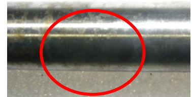
Imagen 1 – Barra oxidada de producto de la competencia, empacado para su venta individual
