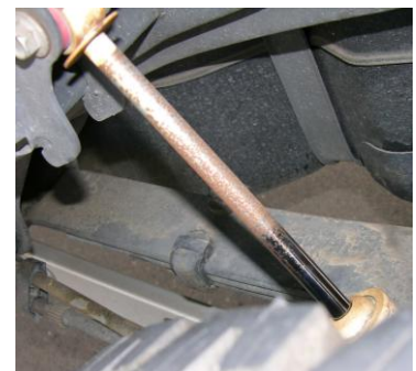
Imagen 2 – El daño prematuro en el sello causa fuga en el amortiguador
